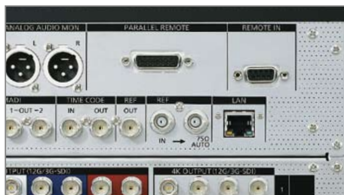
8KレコーダーAJ-ZS0580リアパネルREMOTE端子/LAN端子
