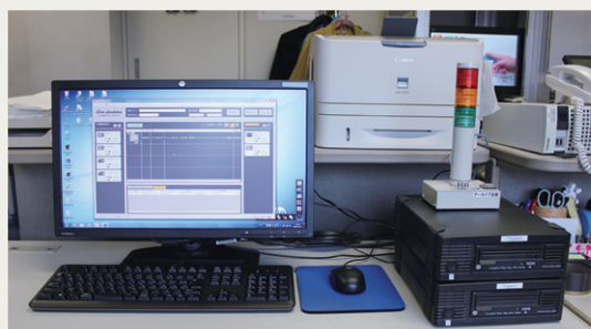
LTOアーカイブシステム LTOドライブ(右下)の上に設置された バトライトは、エラー・アラート監視記録機能 によりエラー発生を知らせます
