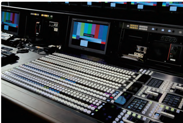
4Kモードで1.5ME、2DSK、18入力・9出力になったコントロールパネル
